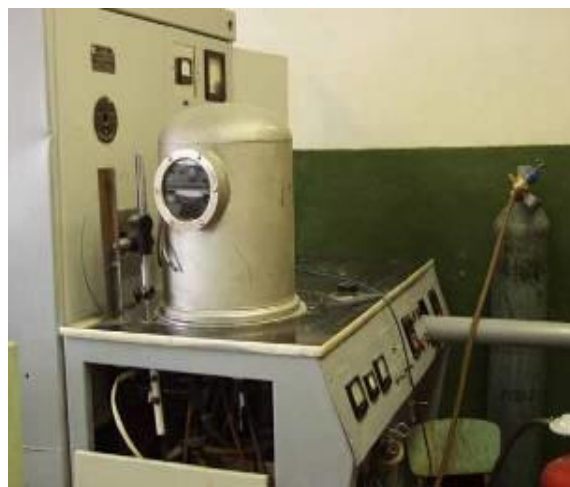
Рисунок 1. Схема и общий вид экспериментальной установки ВЧИ разряда для обработки порошкового материала в «углеволокнистом стаканчике» и «кварцевой колбе»:
